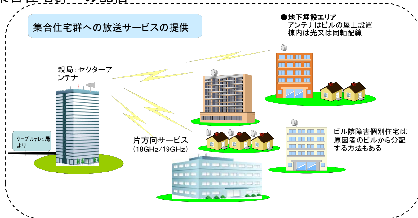
図2.11 複数の集合住宅へのP-MP配信システム概念図
