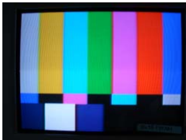
DU35dB TV入力75dB \mu V 画質評価:3+ 許容限:明らかにノイズを確認
