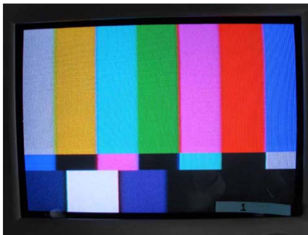
DU40dB TV入力80dB \mu V 画質評価:4 検知限:ノイズを検知できる
